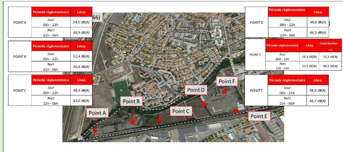
Sur la majorité des points de mesure (A à D), on note un écart jour/nuit de 5dB(A). Cet écart augmente à l'est du site (point E et F) du fait de l'éloignement avec l'A9 structurante.
