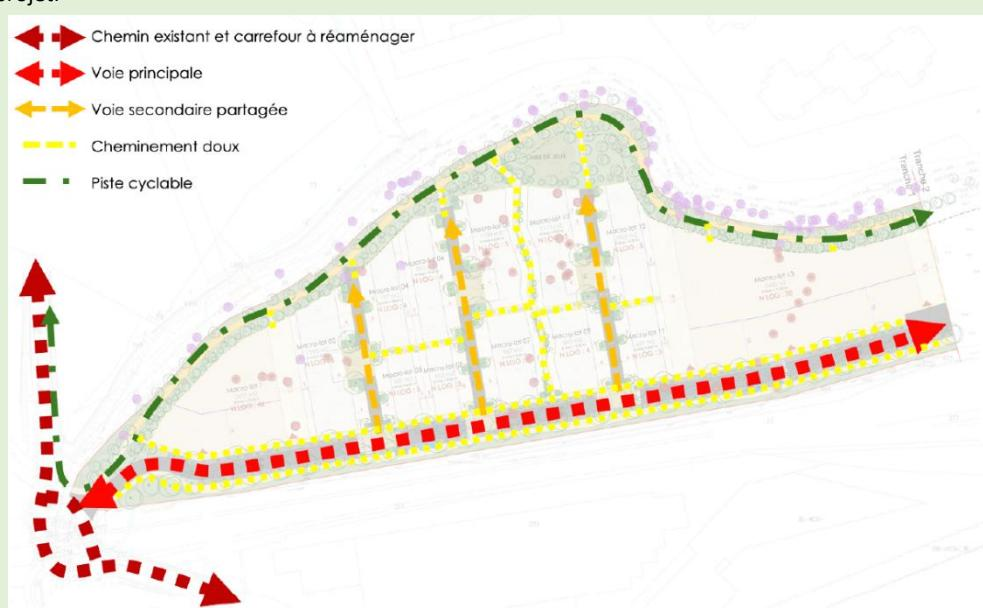
Cette voie longe la voie ferrée et est calibrée pour permettre la circulation de tout type de véhicules, et est accompagnée de chaque côté de stationnements longitudinaux et d'un cheminement mixte pour inciter l'usage des modes de déplacements doux, notamment en direction du centre-ville.
