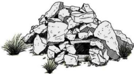
Figure 42 : Pierrier aménagé sur une base de parpaing creux
